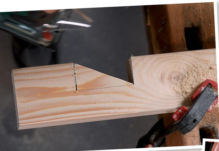
La barre du milieu doit maintenant être encochée, cela signifie qu'un évidement doit être scié.
