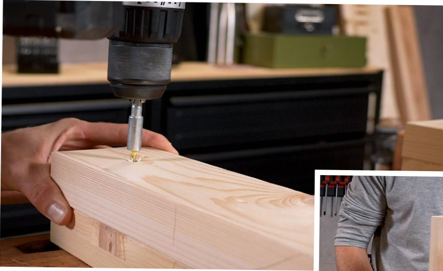
Pour le pied situé au niveau de la tête du banc, les deux parties extérieures sont collées sur la pièce du milieu et vissées fermement.
