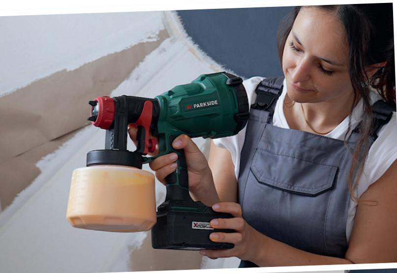
Anschließend füllst du die Mischung in den Farbbehälter der Spritzpistole und stellst die Sprüherichtung ein mit der du beginnen möchtest. Wähle den horizontalen Strich wenn du zu erst von oben nach unten und den vertikalen Strich wenn du zuerst von links nach rechts sprühen möchtest.
