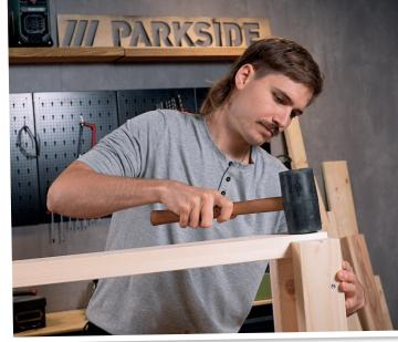
Lege nun die Liegefläche auf und vermittle sie. Zeichne dir eine Markierung an und nehme die Liegefläche wieder runter. Bohre die Löcher im Travers vor damit, wenn du von unten die Liegefläche festschraubst, die Schrauben auch gut in der dünnen Liegefläche anziehen.
