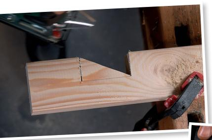
Wie bei allen frischgeschnittenen Flächen, brichst du noch die Kante mit Der mittlere Balken muss nun ausgeklinkt werden, das bedeutet es muss eine Aussparung gesägt werden.
