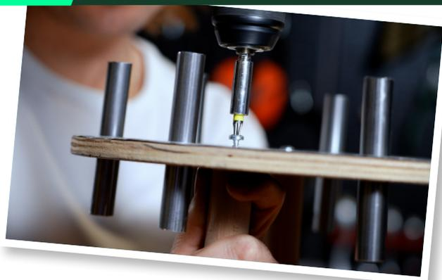
Fixes les tourillons (E) avec un peu de colle dans les trous de perçage et serre-les à travers la tôle d'acier par le haut avec des vis à tête cylindrique bombée (3,5 x 30 mm).
