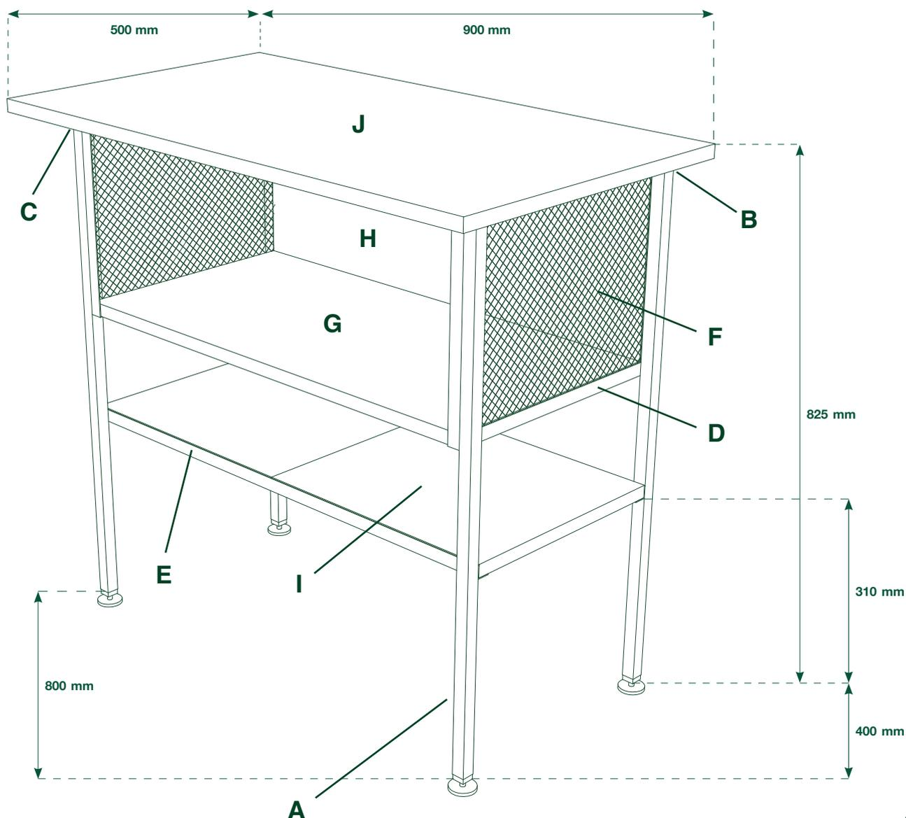
\* Les dimensions exactes ne peuvent être déterminées qu'après l'assemblage de la structure et doivent être adaptées aux dimensions fournies par le client.
